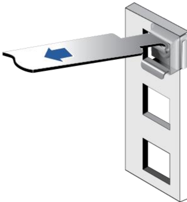
图 6-6 在机柜中安装浮动螺母
