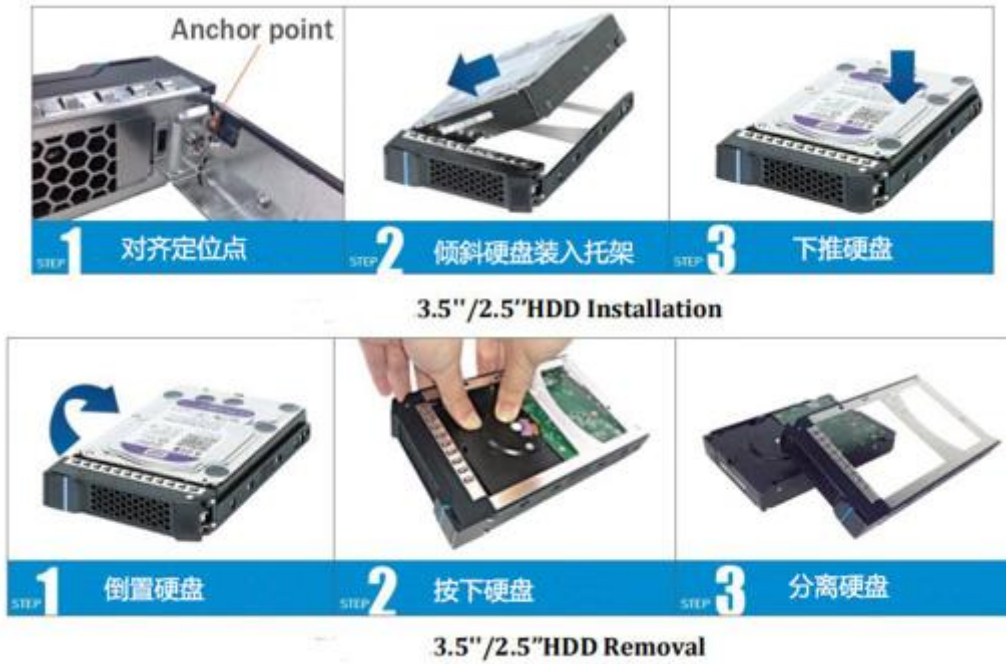
图 2.17 热插拔硬盘的拆卸示意图
