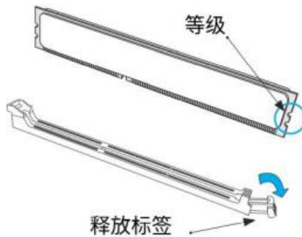
图 3.9 内存安装步骤图 1-2
